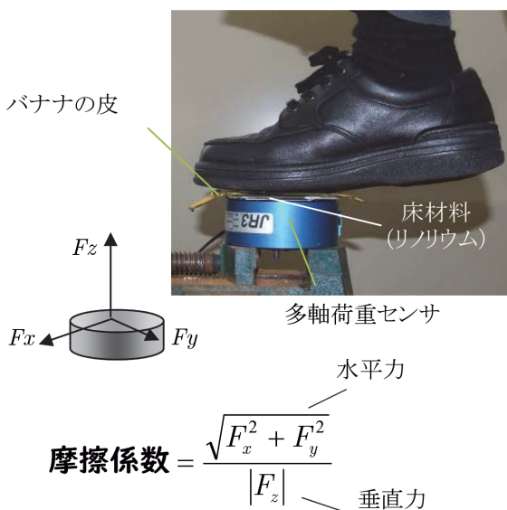
図2 荷重センサを用いた摩擦測定の様子。踏むという条件を再現
