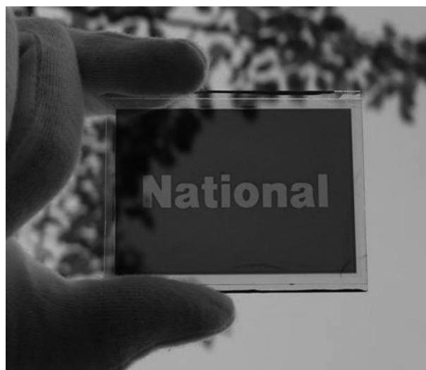
図7 シースルータイプの色素増感太陽電池
