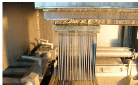
図3-1 150mmインゴットの加工直後の状況(ウェハー厚さ 70\mu\text{m} )
