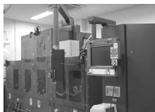
図 2-2 改良後のマルチワイヤ放電スライシング装置
