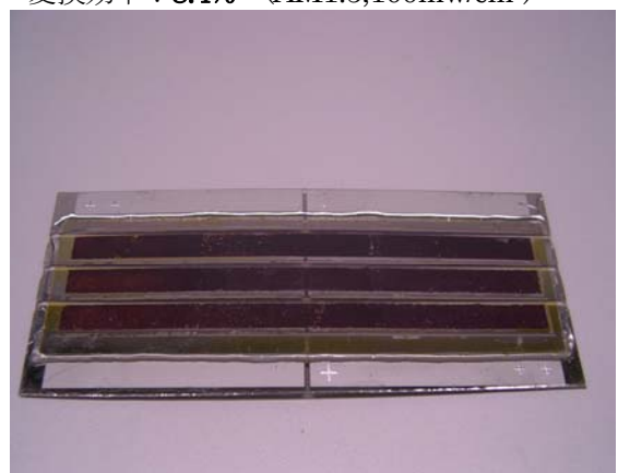
図8 3\text{cm} \times 10\text{cm} のプラスチック厚板基板色素増感太陽電池 (直列集積型)
