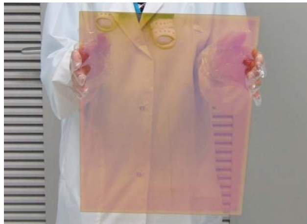
図2 ガラス基板上に作製した水素化アモルファスシリコン膜の外観写真。
